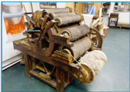
Существует пословица – «прост как валенок», однако это нельзя отнести к процессу изготовления валенок. Процесс создания валенок очень трудоемкий, а технология создания мало изменилась со временем. Нужно сначала подготовить шерсть: очистить и размять, пока она не станет мягкой. Раньше это делали вручную, а позже стали использовать специальные приспособления.
